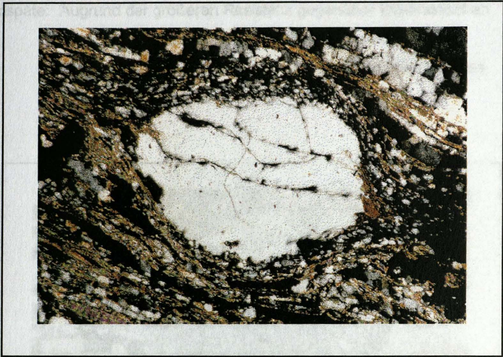
Abb. 15: Schliffnummer 9, Quarzkorn mit erkennbaren intragranularen Rissbildungen, auffallend sind Biotit- "bärte" in den Druckschatten
