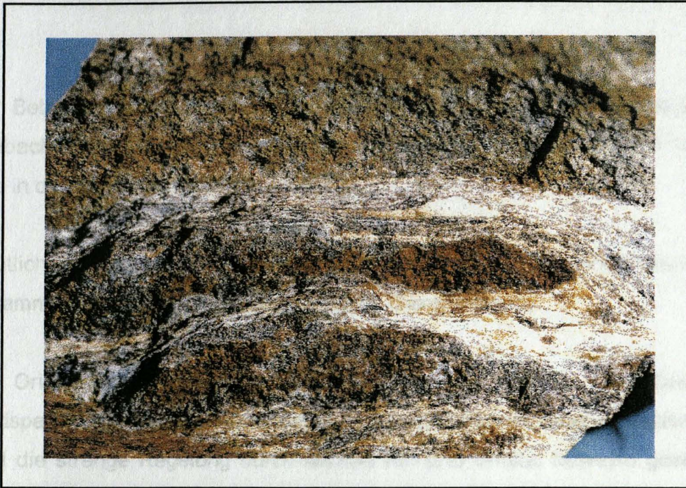
Abb. 12: Probe der Verwitterungsklasse 4, Verwitterung durchdringt den Verband, vollständige Verfärbung, Entfestigung
