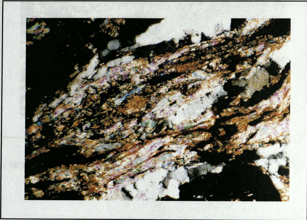
Abb. 18: Schliffnummer 20, strähnige Ausbildung der Glimmer, welche sich vermehrt zwischen den Quarz - bzw. Quarz - Feldspatlagen "einschmieren"
