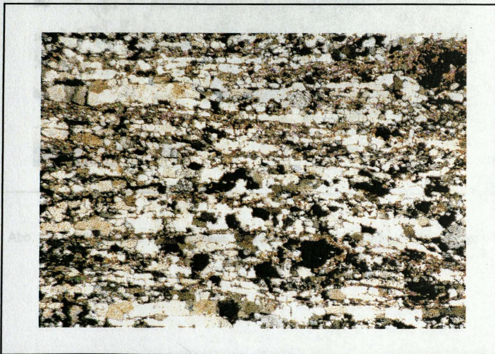
Abb. 13: Schliiffnummer 11, Darstellung der Quarz- Feldspat- Längung ( \pm Regelung), ("ribbon" - Quarz)
