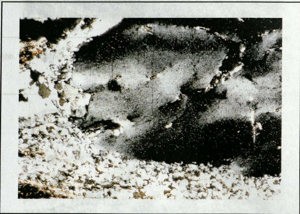
Abb. 14: Schlifffnummer 12, undulöses "Altkorn" mit rekristallisierten Feinkornrand
